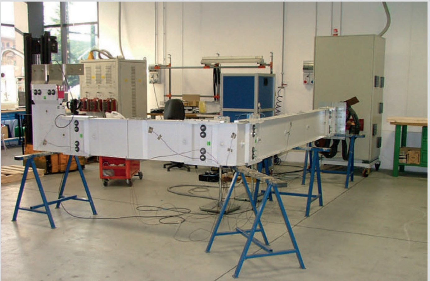
El laboratorio Legrand durante los ensayos para el certificado de homologación de la canalización eléctrica prefabricada SCP.
